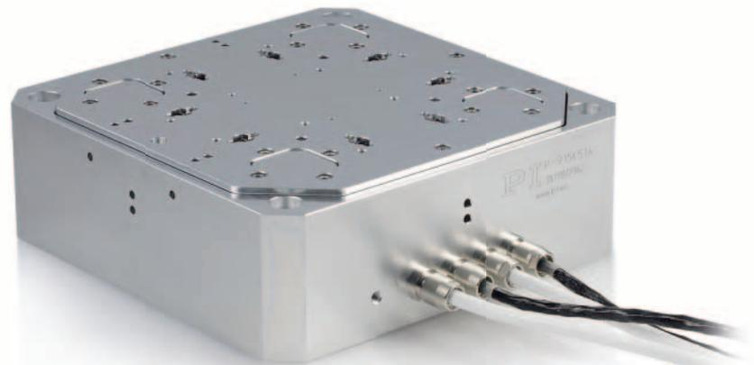
Dieser Piezo-6-Achsen-Tisch wurde für die Physikalisch-Technische Bundesanstalt (PTB) als Objektträger in einem Rasterkraftmikroskop (AFM) entwickelt und ist für den Einsatz in UHV ausgelegt. Die linearen Stellwege betragen  $12\ \mu\text{m} \times 12\ \mu\text{m} \times 10\ \mu\text{m}$ , eine aktive Korrektur der Ablaufgenauigkeit ist durch die Ansteuerung der Kippachsen möglich. Bei einer Last von 300 g erreicht er eine Resonanzfrequenz von über 2 kHz
