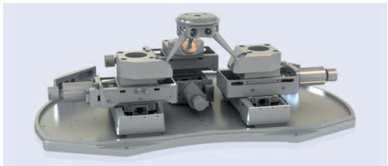
Bei dieser 3-Bein-Konstruktion werden zusätzliche Freiheitsgrade dadurch erzeugt, dass ein passives Bein in zwei oder mehr Achsen bewegt werden kann. Beispiel: Im SpaceFAB treibt je eine XY-Anordnung von Linearverstellern die Einzelbeine an
