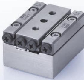
Kompakte Sonderausführung eines Linearverstellers mit NEXACT® Piezoschreittrieb und Präzisionslinearführungen. Die Abmessungen betragen nur 33 mm x 24 mm x 20 mm
