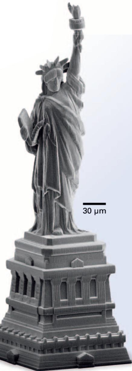
Komplexe dreidimensionale Struktur: Eine 300 µm hohe Freiheitsstatue wurde mit dem 3D-Lithografieverfahren von Nanoscribe erzeugt (Foto: Nanoscribe GmbH)
