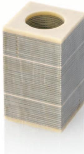
Außerdem können Scherspannungen nicht durch eine mechanische Vorspannung kompensiert werden. Beides begrenzt die sinnvolle Aufbauhöhe von Scherstapeln.
