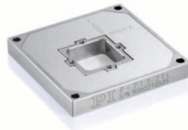
Flacher, preisgünstiger Piezoscanner für die Biometrie: Der CCD-Chip wird dynamisch in zwei Achsen bewegt, um die Auflösung virtuell zu erhöhen
