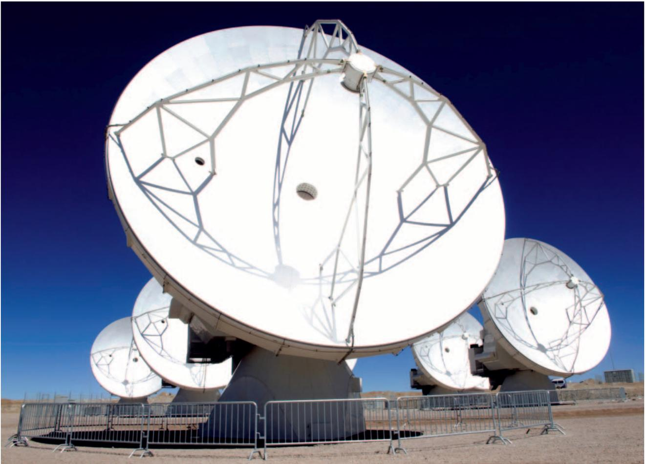
Beim ALMA-Projekt in der Atacama-Wüste in Chile werden bis zu 64 Antennen zu einem riesigen Radioteleskop zusammengefasst. Hexapodsysteme von PI positionieren die Sekundärreflektoren der Teleskope. Die auch gegen extreme Umgebungsbedingungen unempfindlichen Systeme können Massen bis zu 75 kg bewegen (Foto: ALMA (ESO/NAOJ/NRAO))
