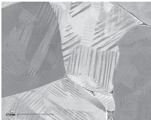
Abb. 2: Der Schnitt durch eine ferroelektrische Keramik zeigt deutlich die unterschiedlich polarisierten Domänen innerhalb der einzelnen Kristallite
