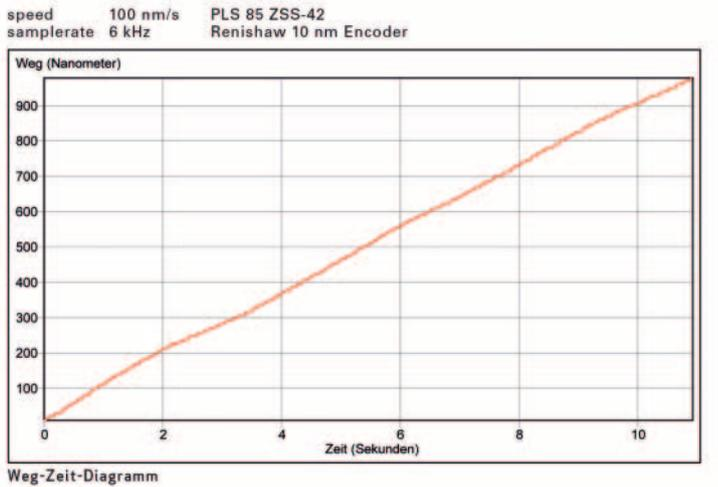
Abb. 4 PLS-85 mit 2-Phasen-Schrittmotor in Regelung, Geschwindigkeit 100 nm/s
