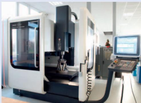
Vorteile der Hexapoden einfach in der Automatisierung nutzen. Neben der SPS-Anbindung ist auch die Ansteuerung über standardisierte G-Code Kommandos möglich
