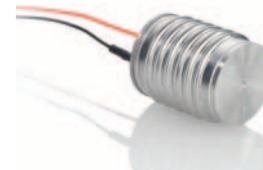
Für Anwendungen in extrem hohen Luftfeuchtigkeiten bzw. in rauen Industrieumgebungen wurden hermetisch gekapselte PICMA® entwickelt. Sie sind mit korrosionsfesten Edelstahlbälgen, Inertgasfüllung, Glasdurchführungen und Laserschweißungen ausgerüstet
