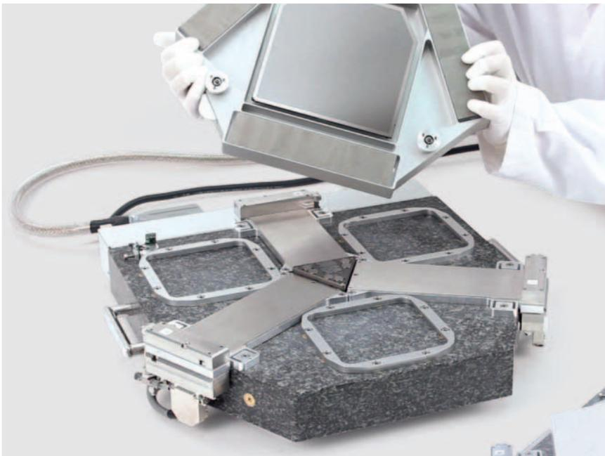
PIMag™ 6D, das Positioniersystem, das auf dem magnetischen Schweben (Magnetic Levitation) basiert: Der passive Läufer schwebt auf einem magnetischen Feld und wird durch dieses aktiv geführt. Objekte lassen sich auf diese Weise mit bisher unerreichter Führungsgenauigkeit in der Ebene linear bzw. rotativ bewegen. Die 6-achsige Bewegung wird über einen 6D-Sensor geregelt, der hochauflösende kapazitive und inkrementelle Sensoren kombiniert
