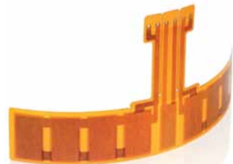
Einlamierte Keramikschichten in einer DuraAct Wandleranordnung (Array)
