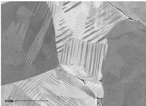
Abb. 2: Der Schnitt durch eine ferroelektrische Keramik zeigt deutlich die unterschiedlich polarisierten Domänen innerhalb der einzelnen Kristallite (Quelle: Fraunhofer-Institut für Keramische Technologien und Systeme IKTS, Dresden)
