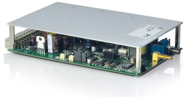
Abb. 8 Bei einer Spitzenleistung bis 280 W und einer Dauerausgangsleistung bis zu 100 W kann der speziell auf die Belange von Niedervoltpiezoaktoren ausgelegte Verstärker einen Spitzenstrom bis 2000 mA abgeben und aufnehmen (Bild: PI)
