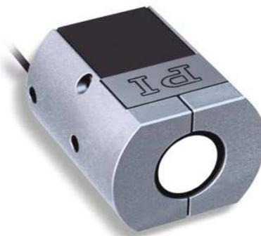
Abb. 3 Kompakter Piezo-Kippspiegel mit zwei orthogonalen Achsen und 100 mrad optischem Ablenkwinkel bei 0,0005 mrad Auflösung; Länge 38 mm (Bild: PI)
